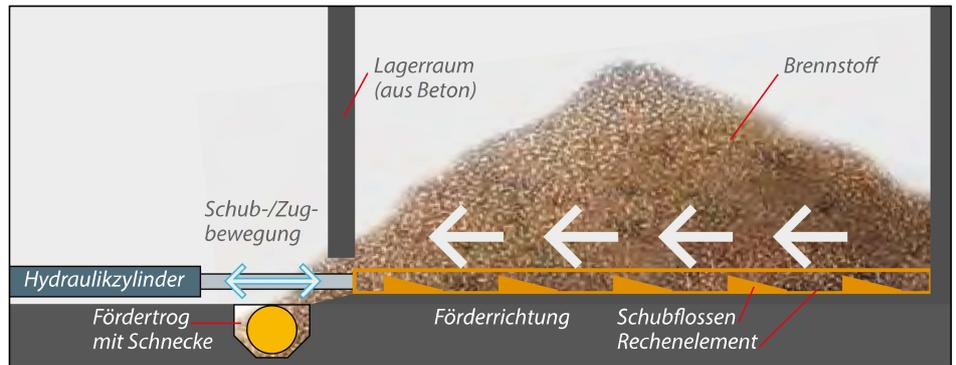
Über Schubflossen, die am Boden des Lagerraums verlaufen, wird das Brennmaterial mittels Schub- und Zugbewegungen zu einem Fördertrug transportiert. Dieser befördert es direkt zur Beschickungseinheit Ihrer HDG Compact Heizanlage.
