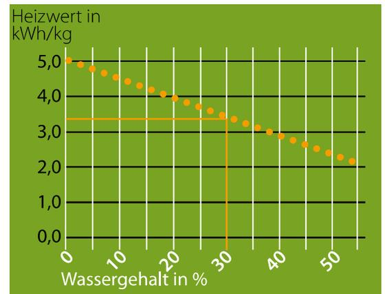
Heizwert von Holz in kWh/kg in Abhängigkeit vom Wassergehalt
