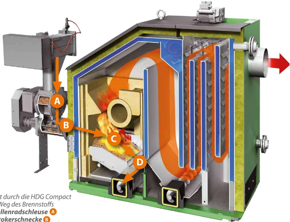
Der Schnitt durch die HDG Compact zeigt den Weg des Brennstoffs von der **Zellenradschleuse A** über die **Stokerschnecke B** zur **Brennkammer C** bis zur **Entaschung D**
