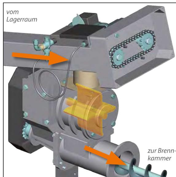
Das HDG Zellenrad entkoppelt die Brennkammer sicher von Lagerraum und Transporteinheit. Das ist die bewährte und patentierte Rückbrandsicherheit von HDG.
