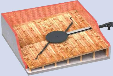
Bei größeren Durchmessern von bis zu 5,7 Metern kann die **HDG Gelenkarm-Raumaustragung** eingesetzt werden. Durch die zwei vorgespannten Arm-Elemente werden auch große Lagerräume mit großen Füllhöhen (5 Meter bei einem Schüttgewicht von 250 kg/m<sup>3</sup>) zuverlässig entleert.
