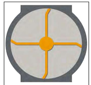
Die patentierte Zellenradschleuse sorgt mit robuster Bauweise und vier Kammern für besonders zuverlässigen Brennstofftransport. Geringe Reibungsflächen ermöglichen einen schonenden und energiesparenden Betrieb.
