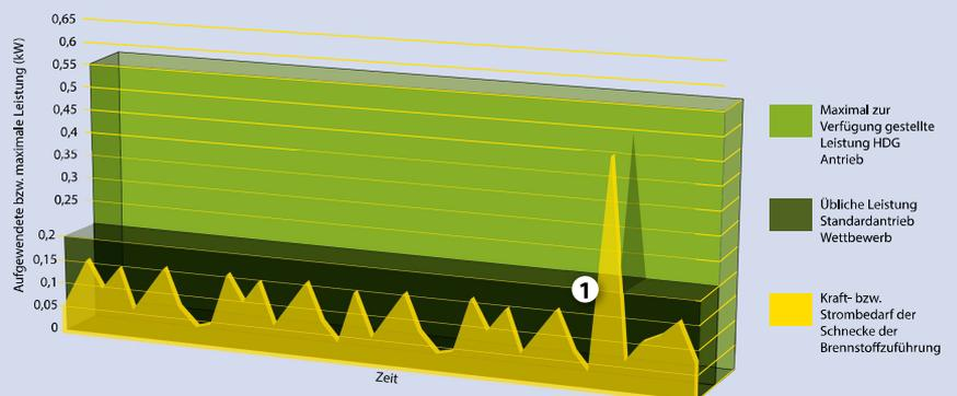
**Der Antrieb der HDG Brennstoffzuführung bietet ausreichend Reserven.** Auch, wenn z. B. durch ein größeres Holzstück kurzzeitig mehr Kraft **1** benötigt wird. Unabhängig davon benötigt ein leistungsstarker Motor bei „normaler“ Belastung nicht mehr Energie als ein schwächerer Antrieb – jedoch bei **wesentlich größerer Betriebssicherheit.**
