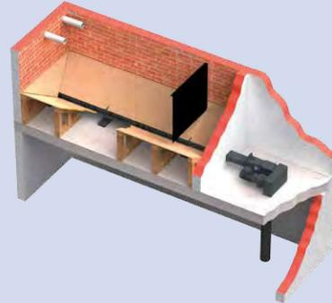
Die **HDG Pellet-Raumaustragung PSZ** ist die günstige Alternative für den reinen Pellet-Betrieb. Ein Druckentlastungsblech schützt die Schnecke gegen das hohe Schüttgewicht der Pellets. So lässt sich eine maximale Füllhöhe von 650 kg/m<sup>3</sup> bzw. 3 Metern realisieren.
