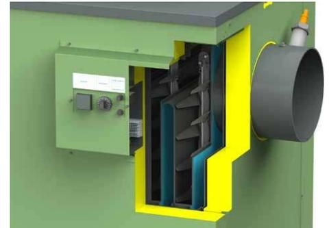
Die Turbulatoren liegen eng an den kompletten Wärmetauscherflächen an und garantieren so eine perfekte automatische Reinigung.
