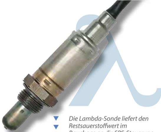
Die Lambda-Sonde liefert den Restsauerstoffwert im Rauchgas an die SPS-Steuerung der HDG Compact. Dadurch werden auch bei verschiedenen Brennstoffeigenschaften – z. B. von Fichte und Buche – die jeweils besten Verbrennungsparameter gewählt.
